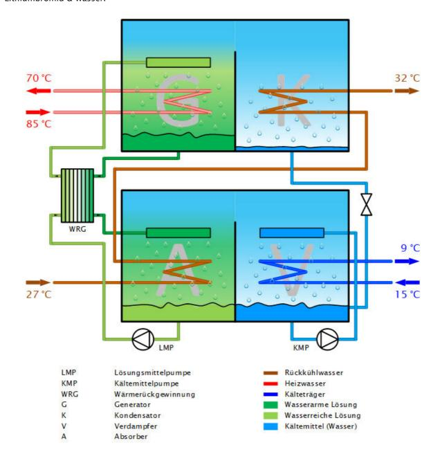
Die angegebenen Temperaturen der einzelnen Kreisläufe sind für den Standard-Betriebspunkt angegeben. Diese Temperaturen können in den technischen Grenzen der Anlage an die jeweils benötigten Projektbedingungen angepasst werden. Mehr dazu finden Sie unter Abschnitt 1.3 auf Seite 5 dieser Beschreibung.
