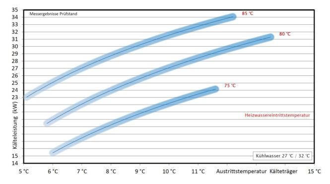
Kennlinienverlauf bei unterschiedlichen Heizwassertemperaturen und Rückkühlwasser 29 / 35 °C. Kälteleistung in Abhängigkeit der Kälteträgereintrittstemperatur in die Absorptionskälteanlage.
